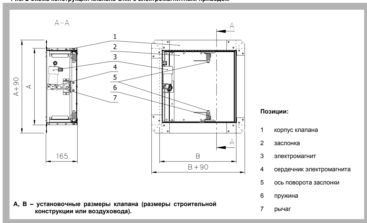
Рис. 2 Схема конструкции клапана ОКМ с электромагнитным приводом
