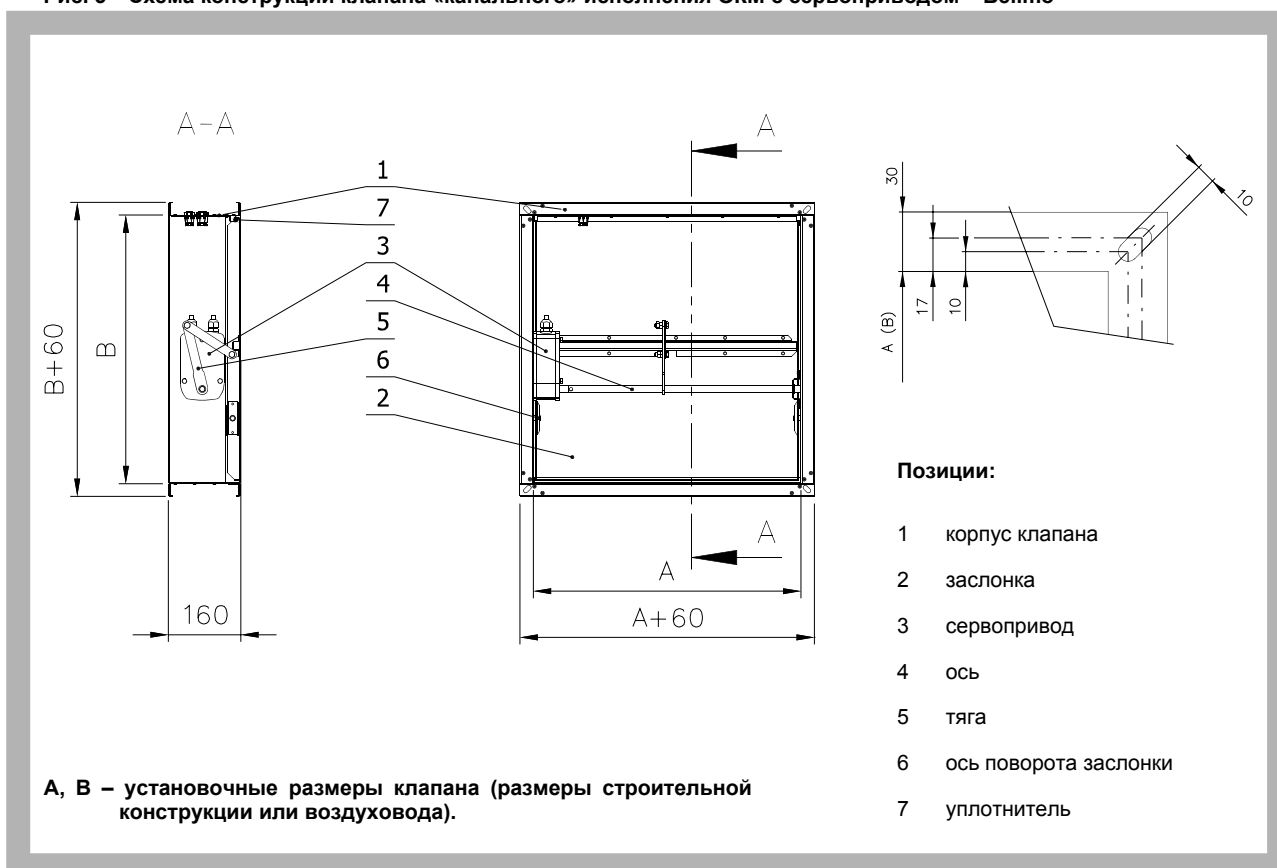
Рис. 5 Схема конструкции клапана «канального» исполнения ОКМ с сервоприводом – Belimo
